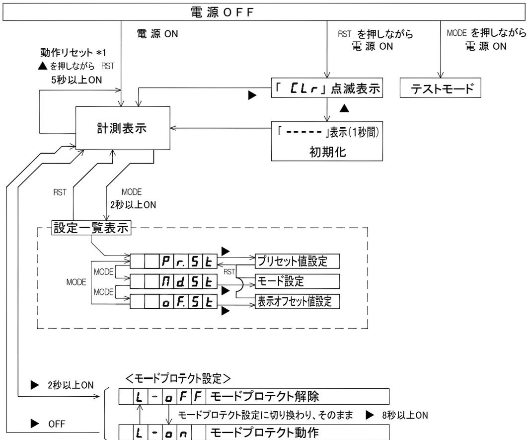
\*1 動作リセット:計測を停止し電源ON時の状態から計測を再開します。
