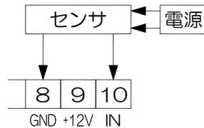
C. 2線式パルスセンサ/有接点出力センサ
